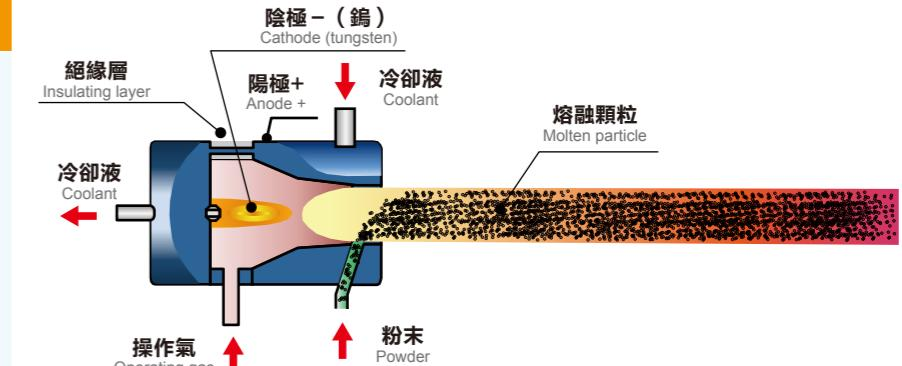
等離子噴塗科技是採用由直流電驅動的等離子電弧作為熱源，將陶瓷、合金、金屬等材料加熱到熔融或半熔融狀態，並以高速噴向經過預處理的工件表面而形成附著牢固的表面層的方法。以使基體表面具有耐磨、耐蝕、耐高溫氧化、電絕緣、隔熱、防輻射、減磨和密封等效能。
