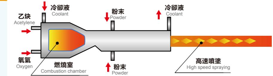
超音速噴塗是在特殊設計的燃燒室裏，將氧氣和乙炔氣按一定的比例混合後引爆，以突然爆炸的熱能加熱融化噴塗材料，並利用爆擊衝擊波產生的高壓把噴塗粉末材料高速噴射到工件基體表面形成塗層。
